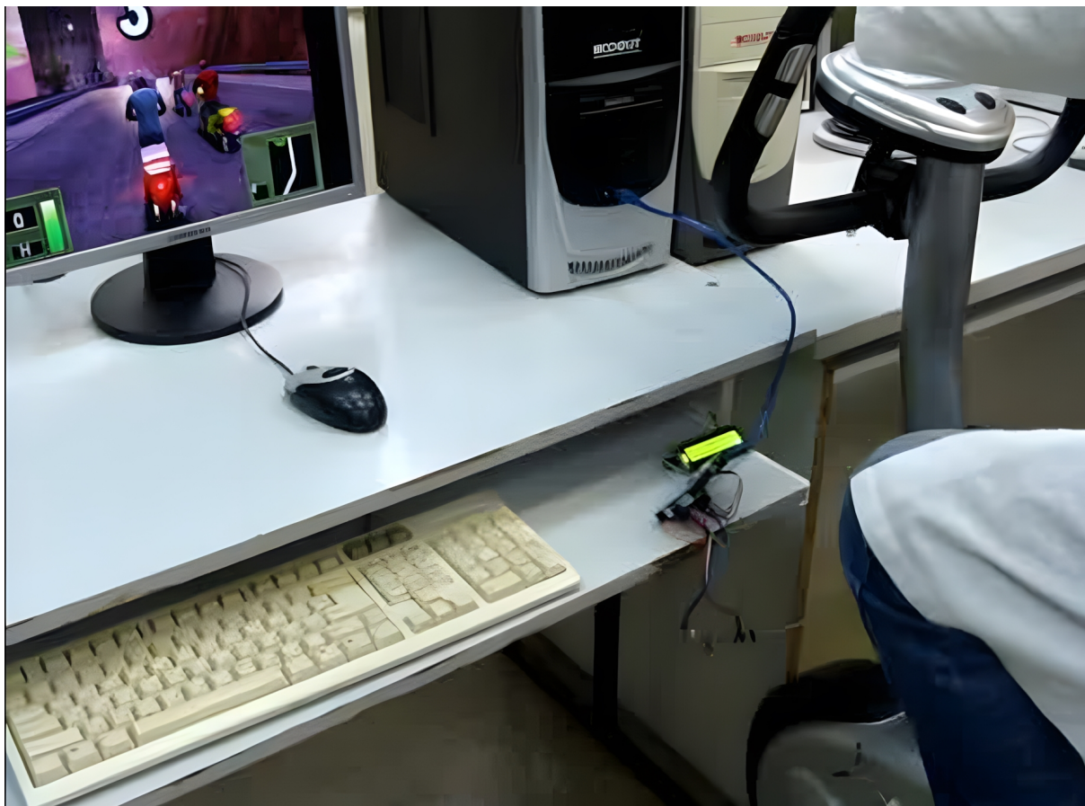
Рис. 2. Проект подключения велотренажера к компьютеру для геймификации (цвет онлайн)
